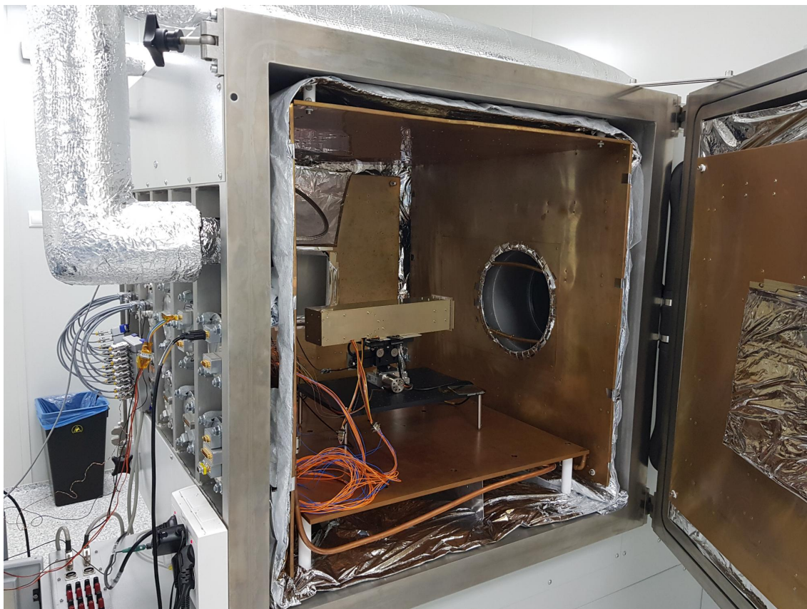
Obrázek 3.3. Termovakuová komora s demonstrátorem. Vnitřní prostor je obložen měděnými štíty, okolo kterých je tepelná izolace. Experiment je orientován svojí podélnou osou na vstup 15m rentgenového tunelu
